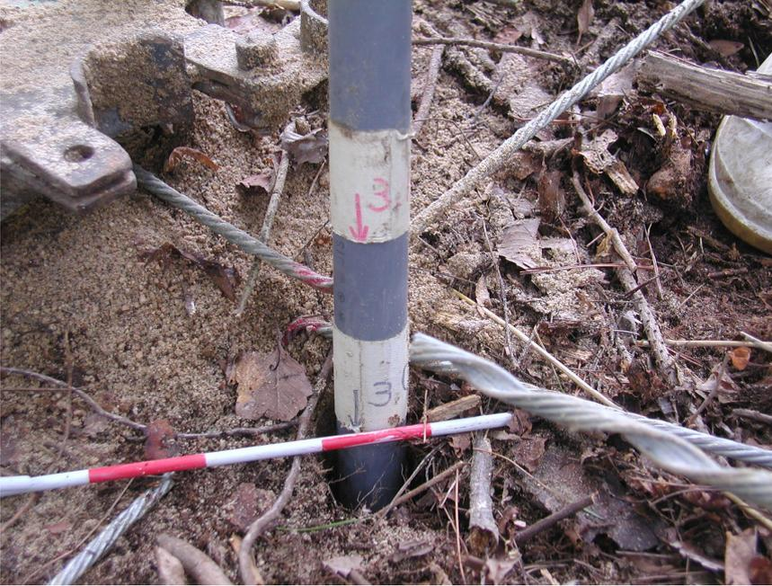
また、塩ビパイプ上端部は、雨水の侵入を防止する処置を行います。
